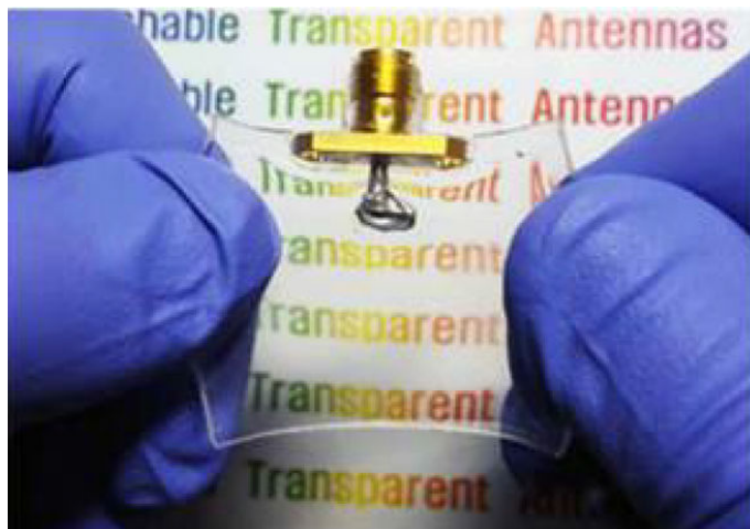
FIGURE 1.9 – Antenne transparente en nanofils d'argent imprimée sur substrat flexible [22]
