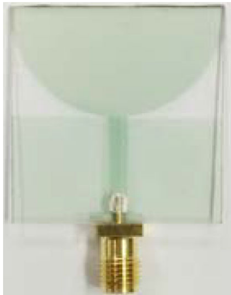
FIGURE 1.7 – Antenne ultra large bande en multicouche IZTO/Ag/IZTO fonctionnant à 6,5 GHz [13]
