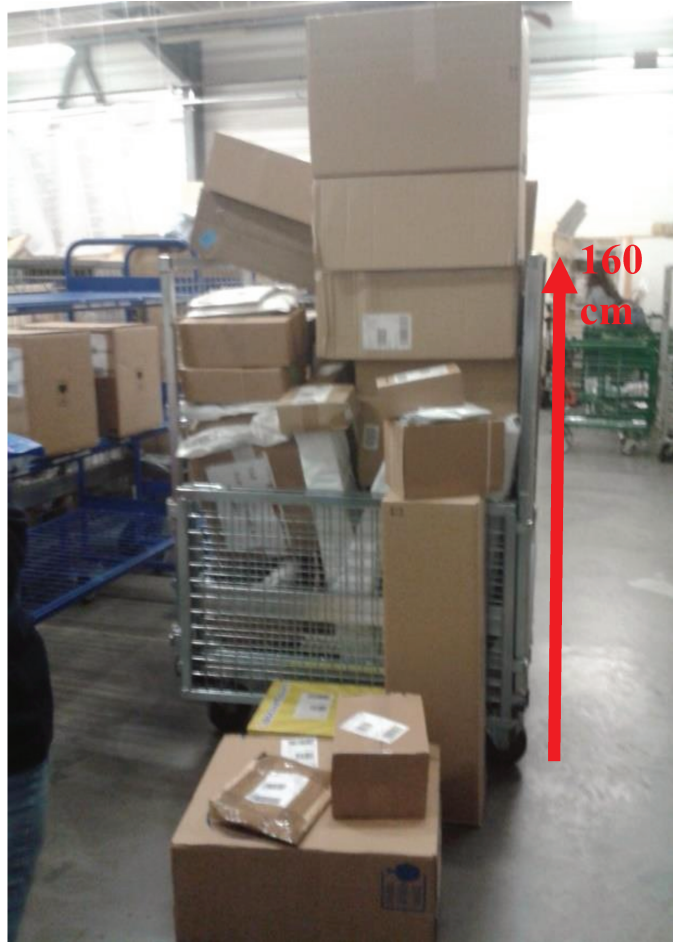
Figure 36 - Photo issue du diagnostic photo représentant un CP660, la structure métallique contenant les colis lorsqu'il y a énormément de colis
