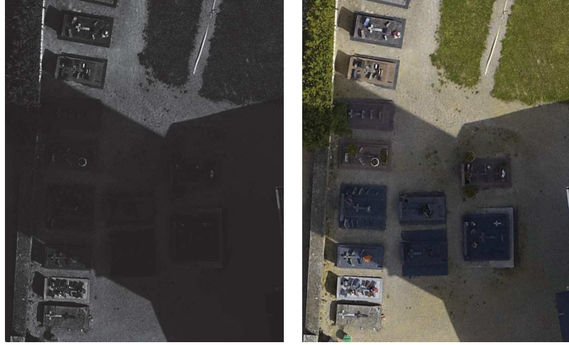
FIGURE 6.7 – Différence entre une image couleur et une image en niveau de gris. L'image en niveau de gris est calculée à partir de la moyenne des composantes couleur.
