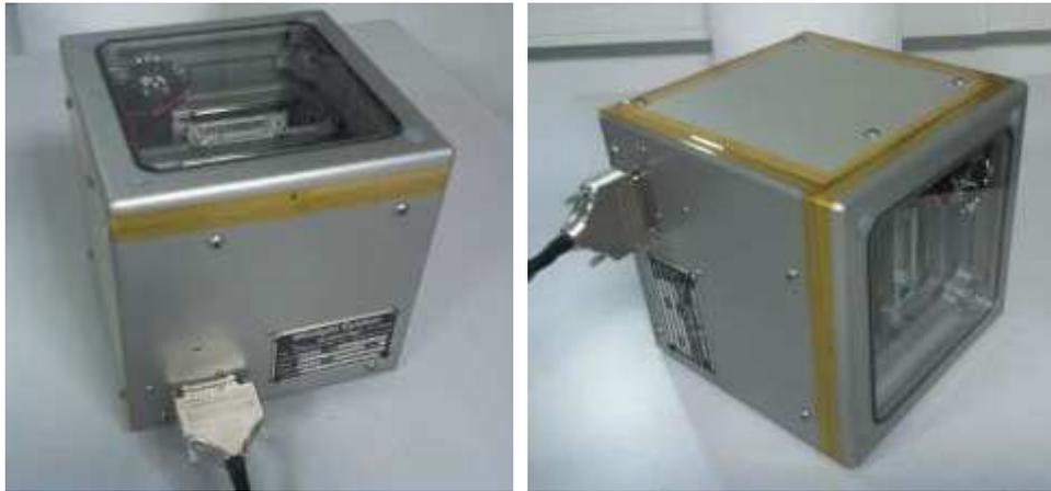
**Figure 46 : Le Cleapart-100, commercialisé par Winlight System. La surface de dépôt peut être placée horizontalement ou verticalement**
