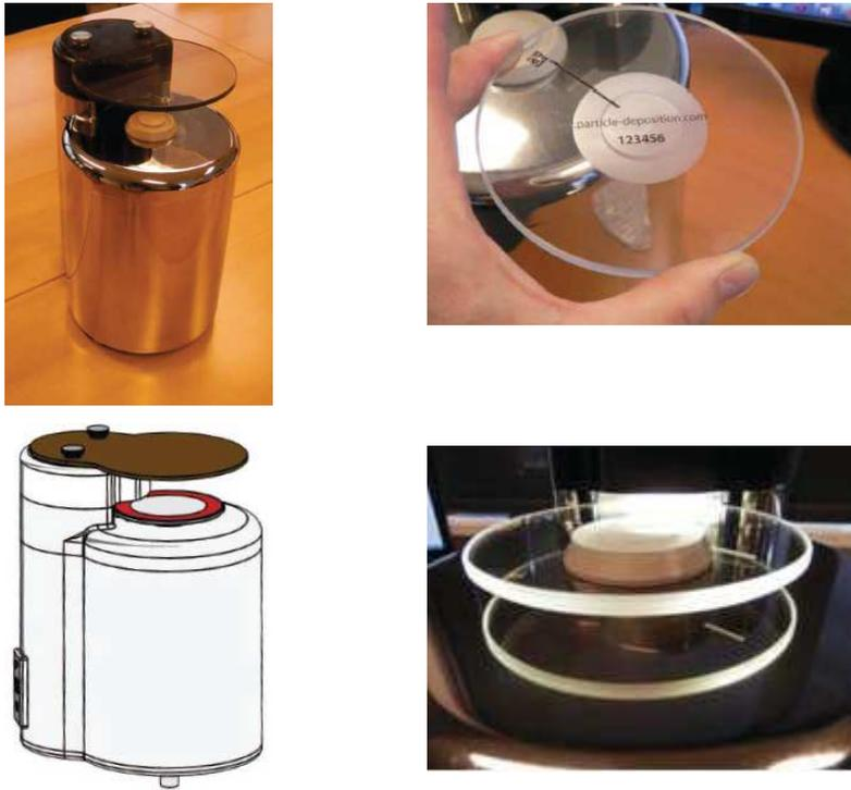
**Figure 44 : Photos et schéma de l'instrumentation développée par SAC Netherlands : le PDM (Particle Deposition Monitoring); les photos de droite représentent la surface de dépôt en verre**
