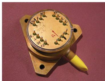
(c) Encapsulation sous vide en boîtier cuivre
