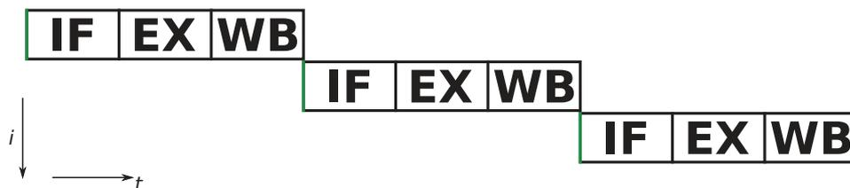
FIGURE E.1 – Exécution d'instructions dans un processeur sans pipeline
