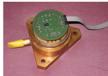
(d) Tête gyrométrique complète avec son électronique de proximité
