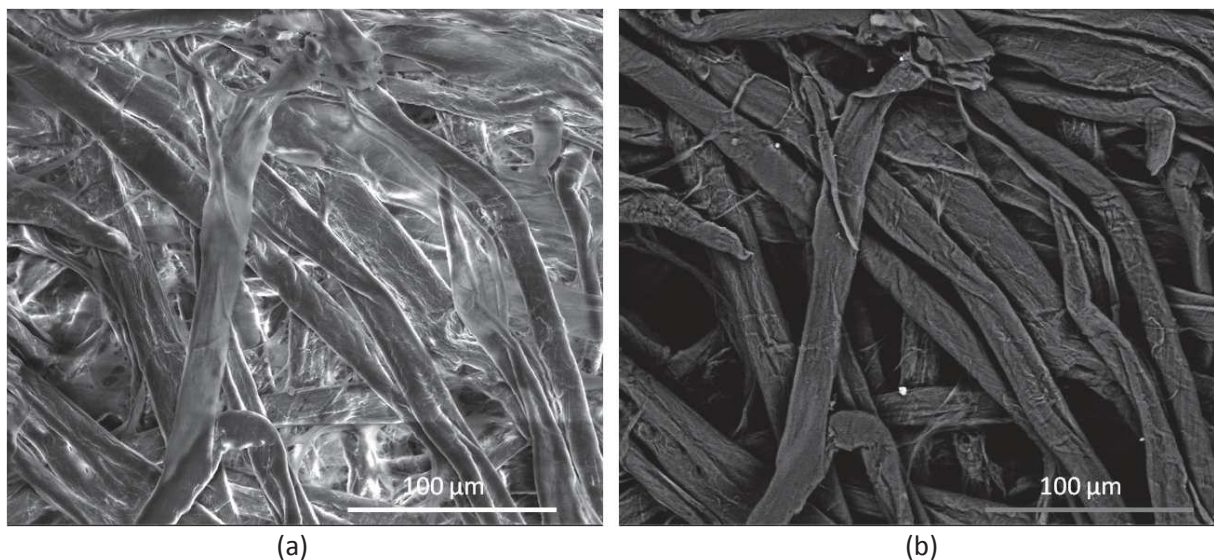
Figure V. 6 : Images MEB en électrons secondaires (a) et, rétrodiffusés (b) de PF.
