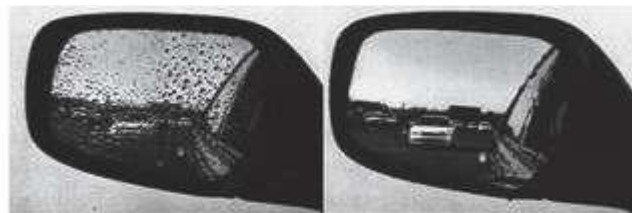
Figure II.2 : Effet anti-buée sur un rétroviseur automobile : miroir conventionnel (gauche) et miroir revêtu d'une couche de TiO 2 (droite) [8].
