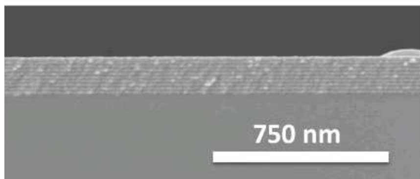
Figure 32 : Images MEB de multi-couches de Al 2 O 3 / ZnO, coupe en tranche. L'épaisseur de deux répétitions de cinq cycles Al 2 O 3 et cinq cycles ZnO est de 24,8 nm
