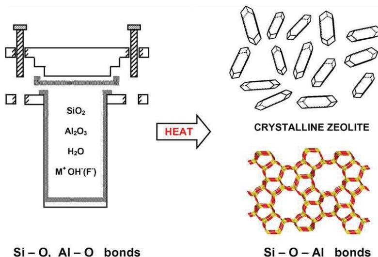
**Figure 7** : Schéma résumé de la cristallisation d'une zéolithe
