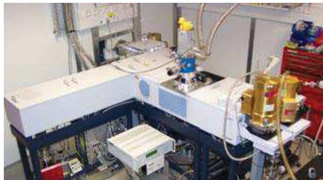
**Figure 31** : Photo d'un des deux dispositifs infrarouge de la ligne AILES du synchrotron SOLEIL.
