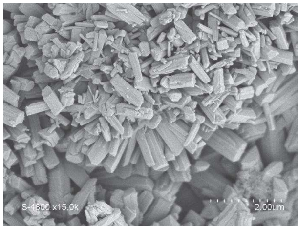
Figure 36 : Cliché MEB réalisé sur la TON (JMT24) obtenue.
