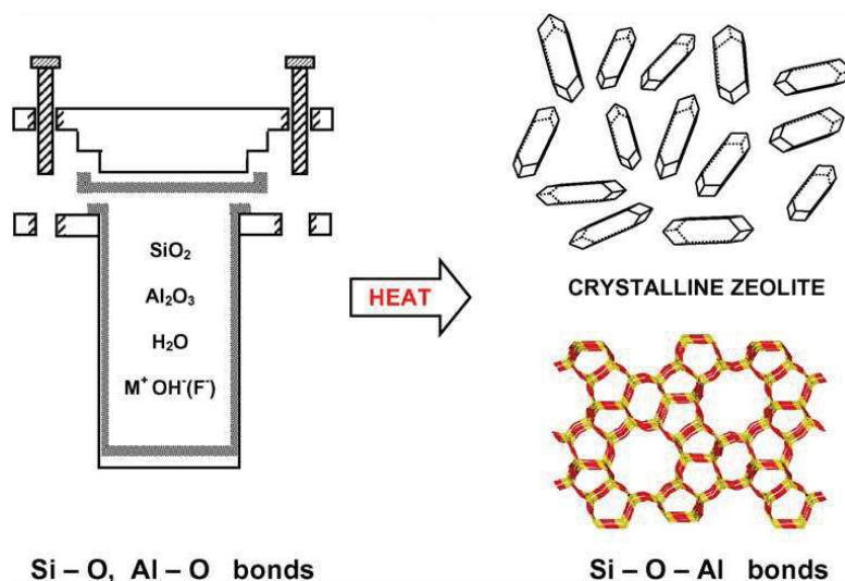
Figure 7 : Schéma résumé de la cristallisation d'une zéolithe
