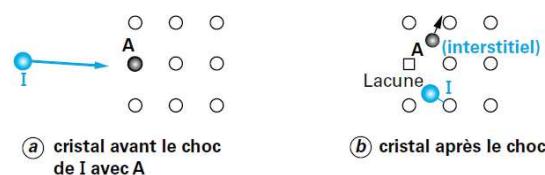
Figure III.44 : Formation d'un défaut primaire par collision d'un ion incident I sur un atome cible
