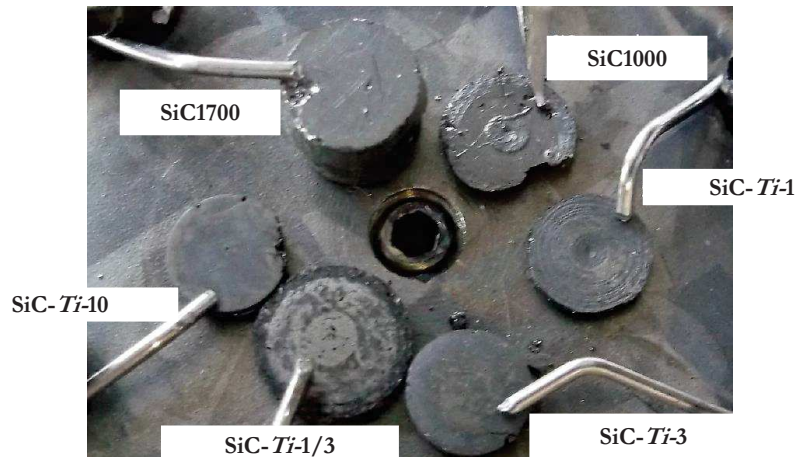
Figure III.46 : Échantillons SiC1000 , SiC1700 et SiC-Ti-X (implantation He, 50keV, fluence 10^{17} \text{ cm}^{-2} )
