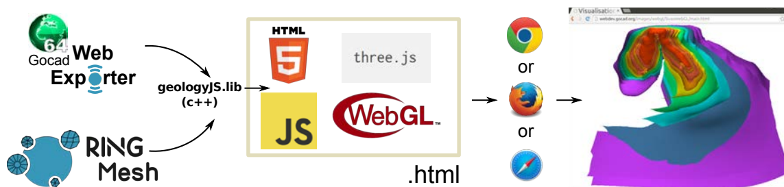
FIGURE B.1 – Workflow d'export pour la visualisation des modèles structuraux avec un navigateur internet. Le plugin WexExporter et la bibliothèque geologyJS ont été codés par nos soins. Un export avait été ajouté à RINGMesh par Benjamin Chauvin mais il n'est plus maintenu actuellement. SKUA-GOCAD, Three.js et les navigateurs sont des logiciels préexistants qui n'ont pas été modifiés.
