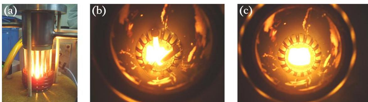
Figure 25 : Charge en fusion dans le four (a), vue de l'intérieur du creuset en début de fusion (b) et en cours de fusion (c)
