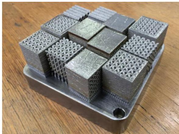
Figure 110 : Structures biomimétiques fabriquées en Ti-26Nb par SLM
