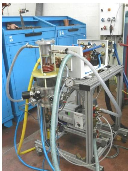
Figure 24 : Four à semi-lévitation magnétique en creuset froid du LEM3
