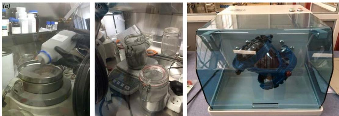
Figure 67 : Etapes pour le mélange des poudres (a) tamisage, (b) pesée, (c) mélange
