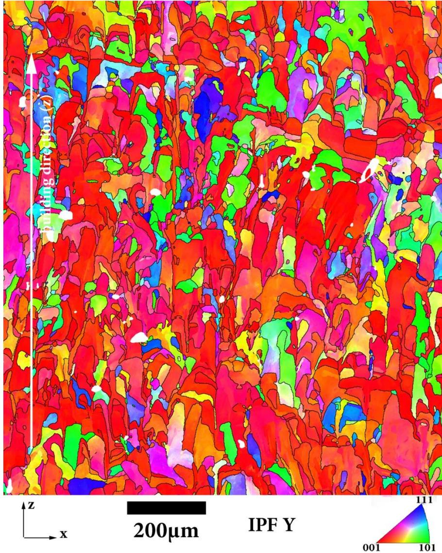
Figure 62 : Carte EBSD en IPF Y, vue de côté de l'échantillon : plan xz
