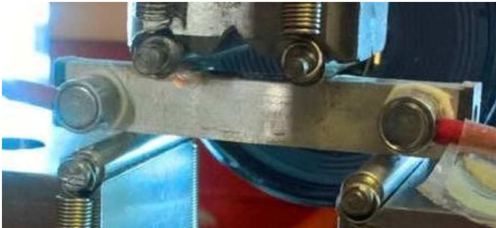
FIGURE 4.12 – Montage expérimental de l'essai de flexion 4 points bi-matériaux.
