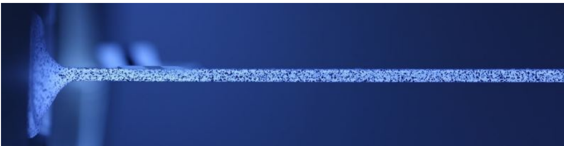
FIGURE 2.15 – Mouchetis pour la DIC sur une baguette Z.
