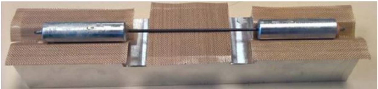
FIGURE 2.19 – Éprouvette des essais de traction sur baguette Z.
