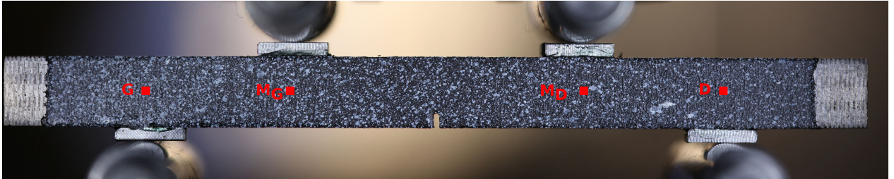
FIGURE B.6 – Mouchetis appliqué à la surface latérale d'une éprouvette permettant la mesure des champs de déplacement au cours d'un essai de flexion 4 points.
