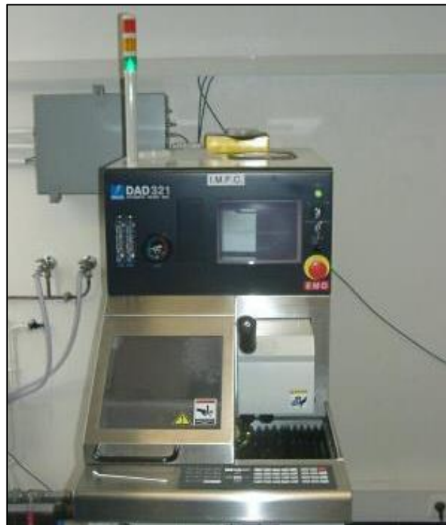
Figure 3.12: Scie de précision DISCO DAD 321 [5]
