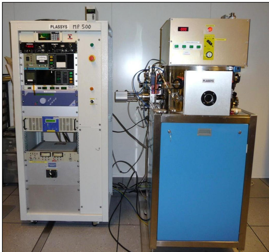
Figure 3.9 : Machine de pulvérisation cathodique PLASSYS MP 500
