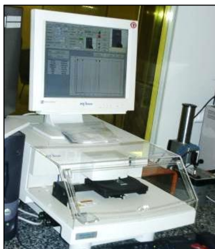
Figure 3.15 : Profilomètre Tencor Alpha Step IQ [5]
