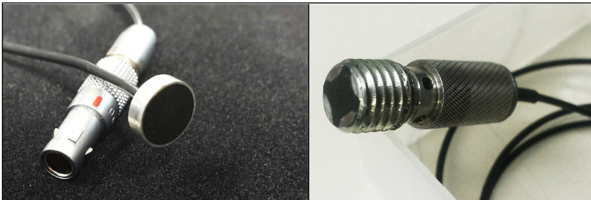
Figure 3.31 : Photographies de fluxmètres thermiques réalisés et assemblés sur leurs supports
