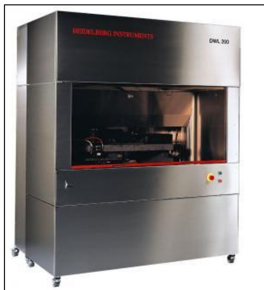
Figure 3.2 : Masqueur Lithographie Optique Heidelberg DWL 200
