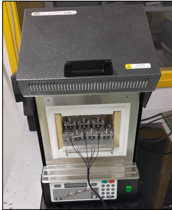
Figure 3.30 : Banc d'assemblage des capteurs de flux à l'intérieur du four Vulcan 3-130
