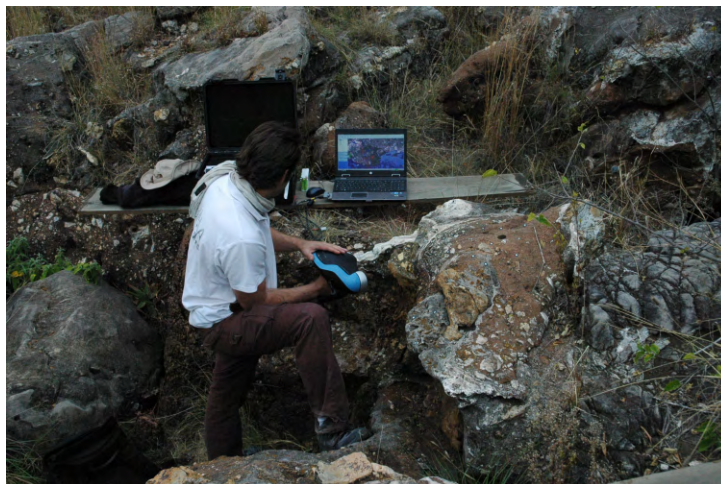
FIGURE 2.21 – Utilisation du scanner à main sur le terrain. Le scanner est relié à un ordinateur, le modèle 3D s'affiche en temps réel. Des pastilles rondes ont été positionnées sur la zone à numériser.
