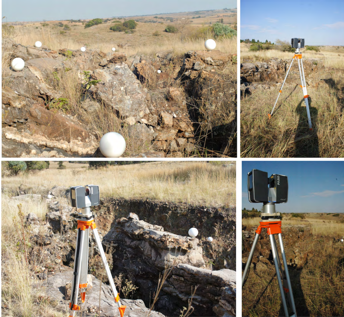
FIGURE 2.14 – Illustration montrant les sphères placées sur le terrain qui sera numérisé et exemples de position du scanner sur le site.
