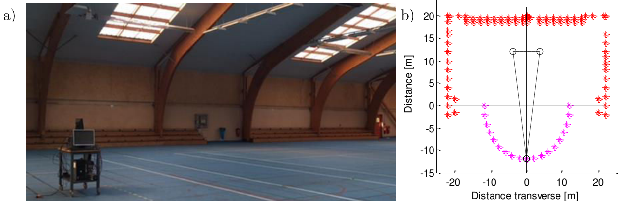
Figure D-1 : a) Environnement de mesure b) Emplacements des points brillants (croix rouges) de l'environnement de mesure et visibilité de la scène pour l'angle d'ouverture des cornets en azimut, \varphi = 0^\circ
