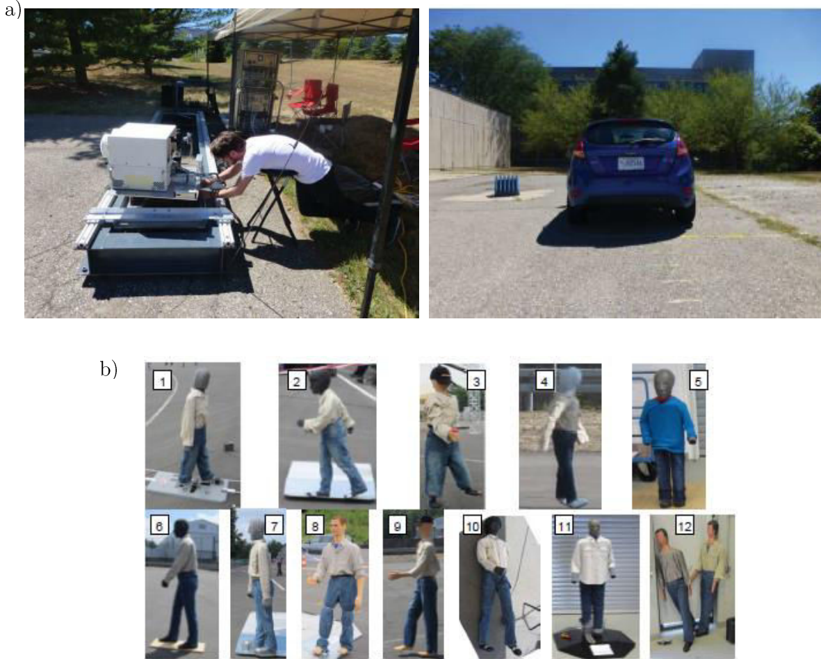
Figure 1-25 : Quelques bancs de mesure des cibles radar dans un milieu réel en bande W
