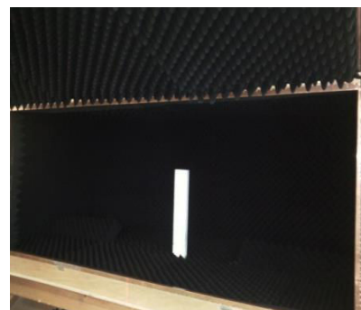
Figure 2-24 : Effet du support sur la précision de la mesure
