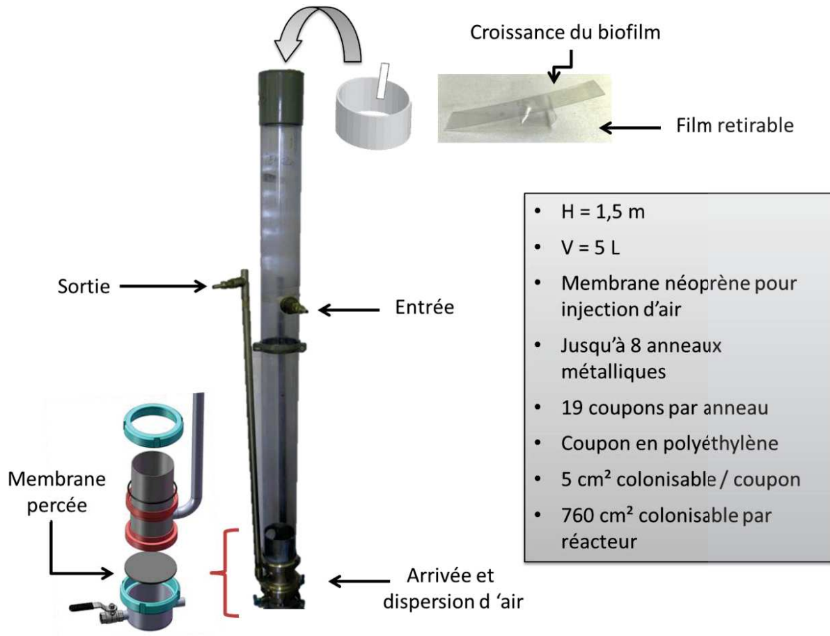
Figure II-3 : Schéma et caractéristiques des colonnes à bulles utilisées
