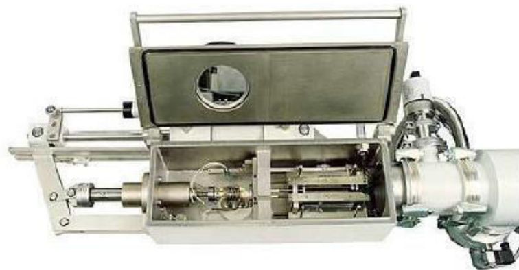
Fig.II.4 : Chambre de chauffage du Dilatomètre BAHR Thermoanalyse GmbH DIL805 [15]
