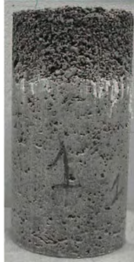
Figure 1.7 Illustration du phénomène de ségrégation sur un mortier de caoutchouc [8].
