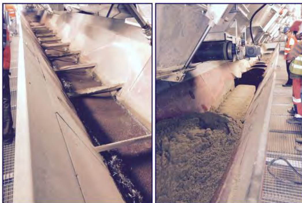
Figure 1.45 Introduction manuelle des billes d'argile et des granulats en caoutchouc en centrale BPE
