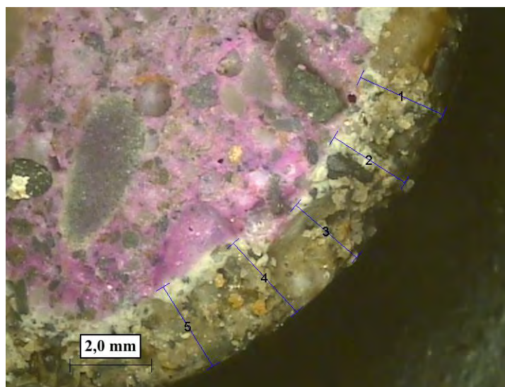
Figure 2.21 Illustration de la mesure de profondeur dégradée par microscope vidéo et indicateur coloré sur le mortier REF après 16 jours d'attaque dans une solution d'acide acétique de pH 4,5
