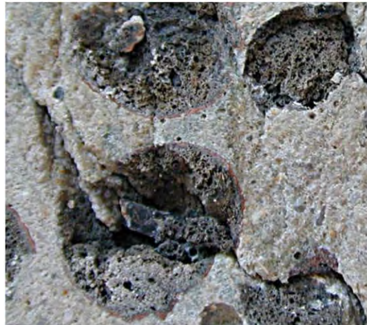
Figure 1.14 Rupture transgranulaire de billes d'argile expansée avec la coque restant collée à la matrice [28]
