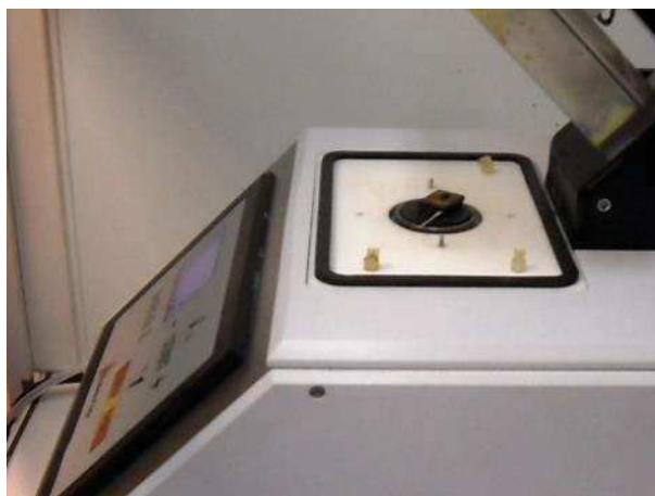
FIGURE 2.15 – Composant placé face en bas pour une ouverture chimique à la Jetetch.
