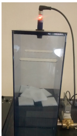
FIGURE III.5: Photo du scénario de 7 objets flottants introduits dans la cuve principale et son impact sur le signal.
