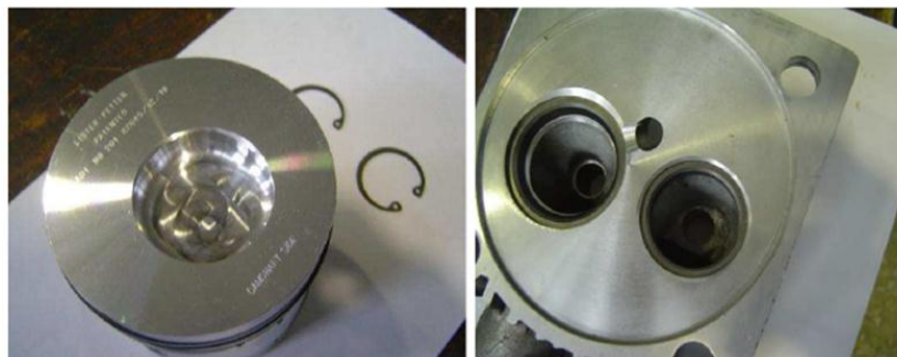
Figure II.1 : Photo représentative du piston et de la culasse du moteur Lister-Petter.
