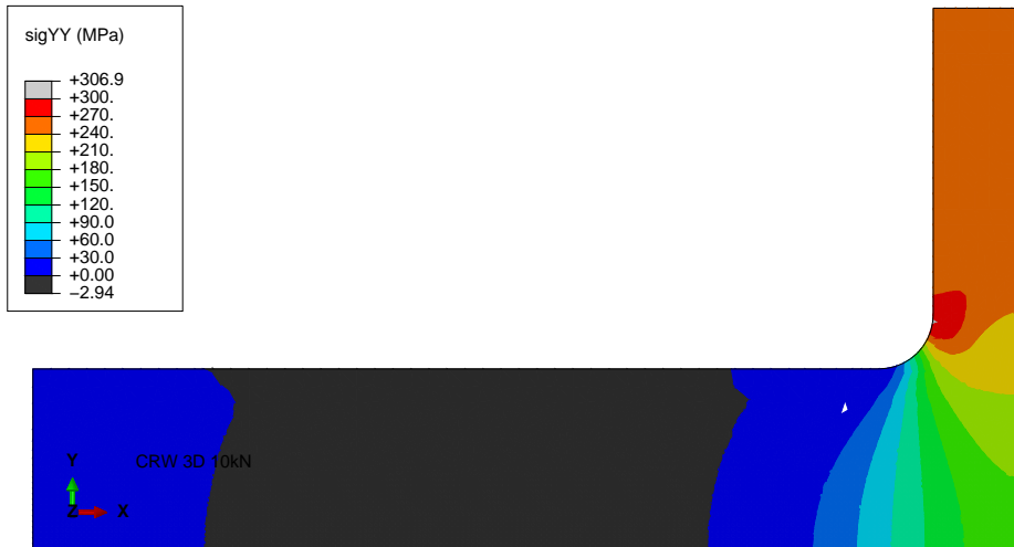
FIGURE 4.12: Isovaleurs de la composante de contrainte \sigma_{yy} pour F_0 = 10 kN (visualisées sur un quart d'éprouvette)
