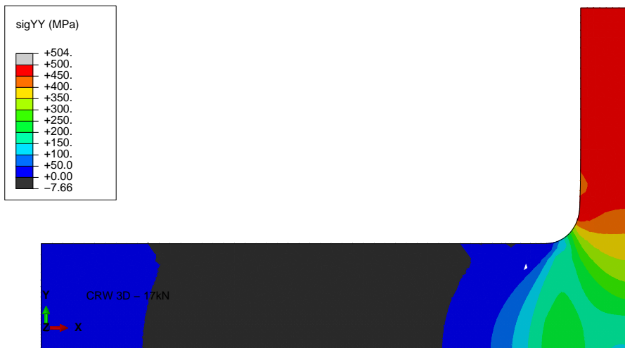
FIGURE 4.13: Isovaleurs de la composante de contrainte \sigma_{yy} pour F_0 = 17 kN (visualisées sur un quart d'éprouvette)
