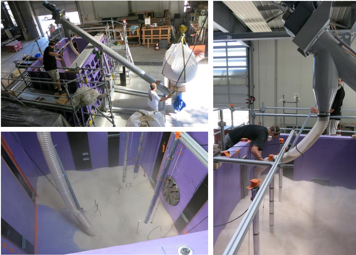
Figure II-19 – Remplissage du “bac” à sable pour la reconstitution du massif de sol à excaver à l’aide d’une vis sans fin et d’un tuyau en caoutchouc
