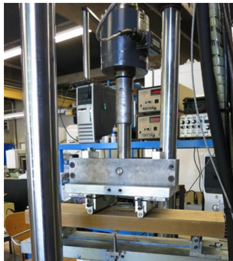
Figure IV-25 – Schéma de principe et photo du banc d'essais de flexion 4 points utilisé à l'ENTPE
