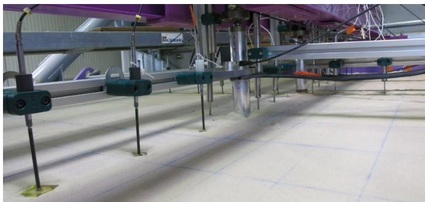
Figure II-31 – Capteurs de déplacements de la surface du sol
