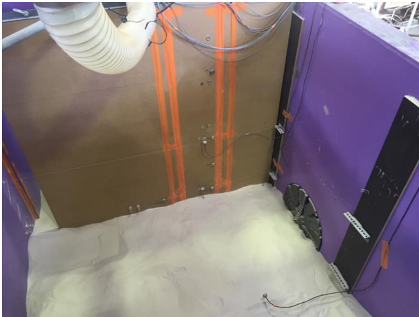
Figure IV-31 – Modèle de paroi moulée utilisée pendant les essais sur modèle réduit de tunnelier à pression de terre: (a) instrumentation avec jauges d'extensométrie, (b) en position dans le caisson pendant la confection du massif.
