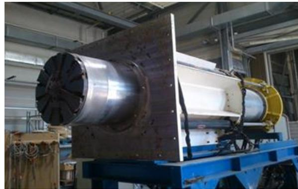
Figure II-5 - Le modèle réduit de tunnelier à pression de terre de l'ENTPE
