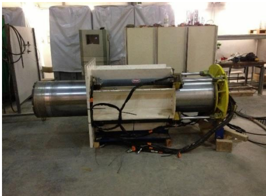
Figure II-16 – Désassemblage de l'ancien dispositif de tunnelier à pression de terre de l'ENTPE avant reconfiguration.
