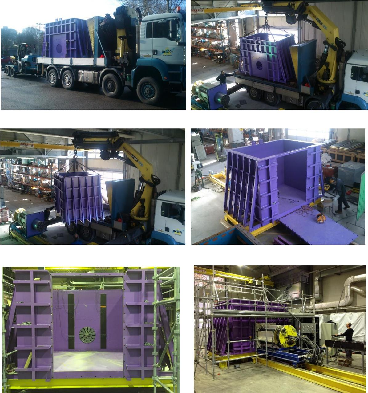
Figure II-17 – Assemblage du nouveau du nouveau dispositif de tunnelier à pression de terre conçu dans le cadre de cette thèse.
