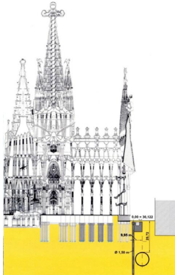
Figure IV-7 Coupe transversale du tunnel à Sagrada Familia, Barcelone. Katzenbach, R et al., (2013)
