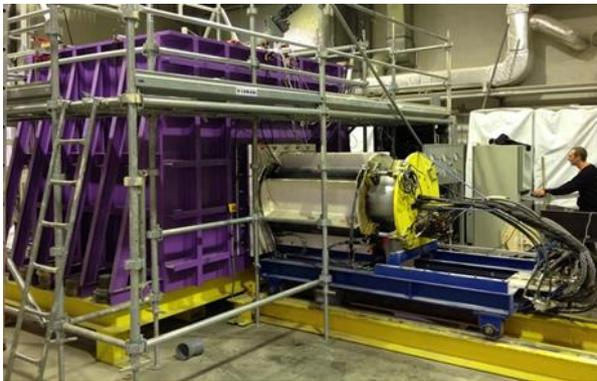
Figure II-4 - Vue d'ensemble du dispositif expérimental (tunnelier + caisson)
