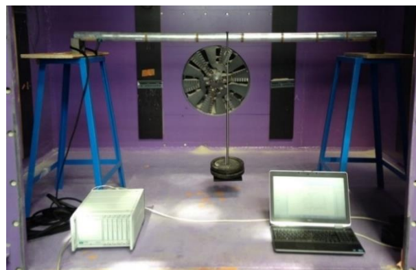
Figure II-44 – Dispositif de flexion 3 points pour la calibration des moments de flexion dans les pieux
