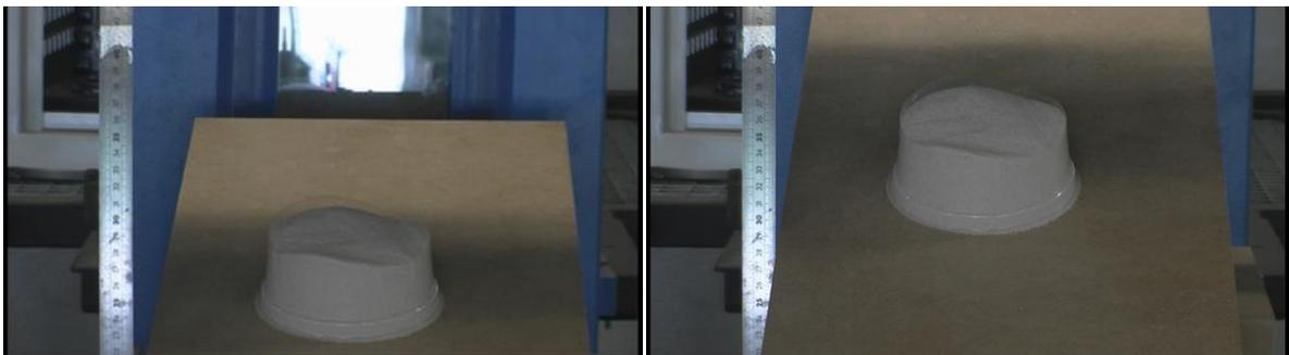
Figure IV-28 – Dispositif de plan incliné pour mesure de l'angle de frottement d'interface Medium/ sable
