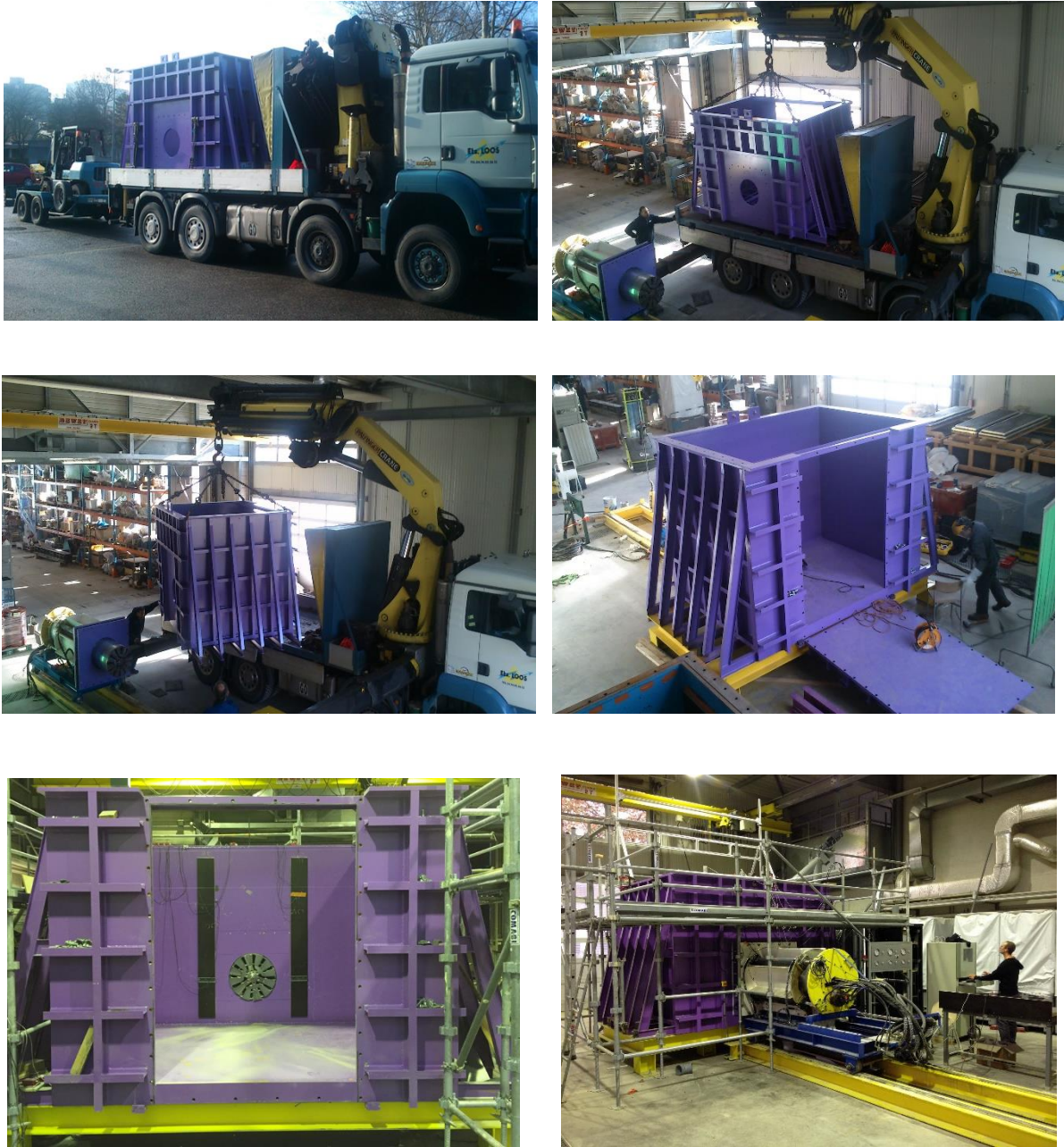
Figure II-17 – Assemblage du nouveau du nouveau dispositif de tunnelier à pression de terre conçu dans le cadre de cette thèse.
