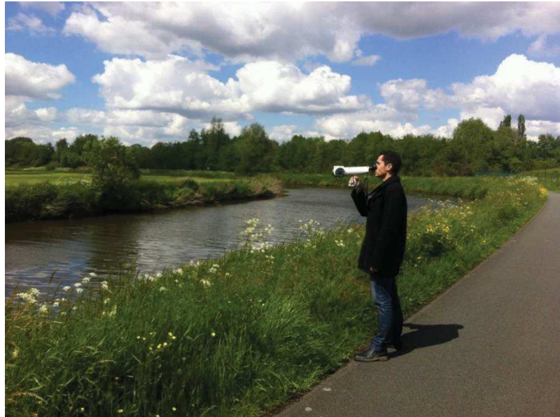
Figura 4.5 – Medição de odor utilizando o Nasal Ranger® Field Olfactometer.
