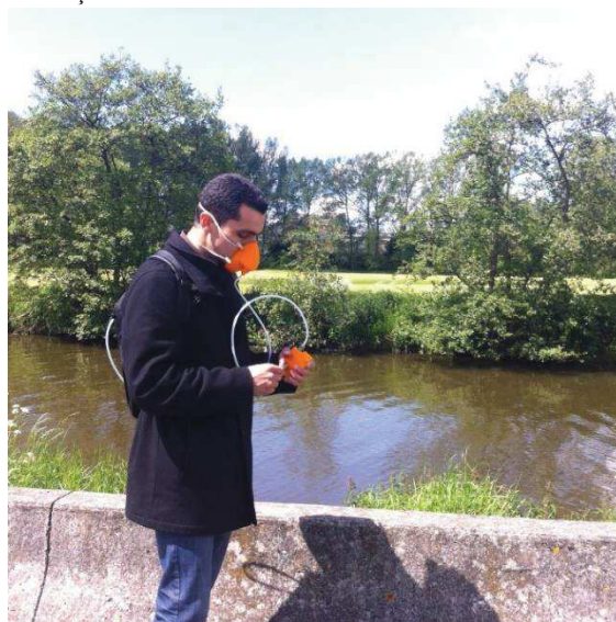
Figura 4.6 – Medição de odor utilizando o Scentroid SM110 Field Olfactometer.
