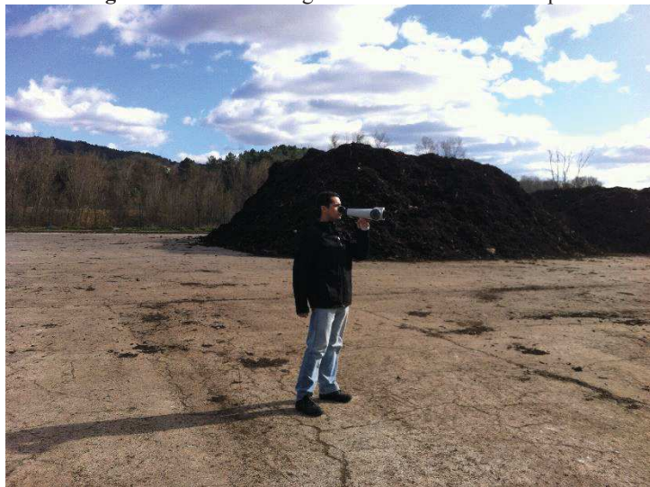
Figura 4.2 – Nasal Ranger ® sendo testado em campo.
