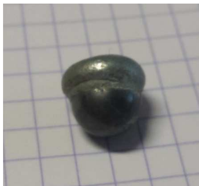
Figure 41 : bille de CW prise dans une "ganguie" de zinc après un essai de broyage avec des morceaux de zinc
