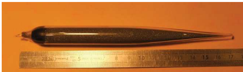
Figure 37 : ampoule utilisée pour la synthèse selon le procédé Bridgman
