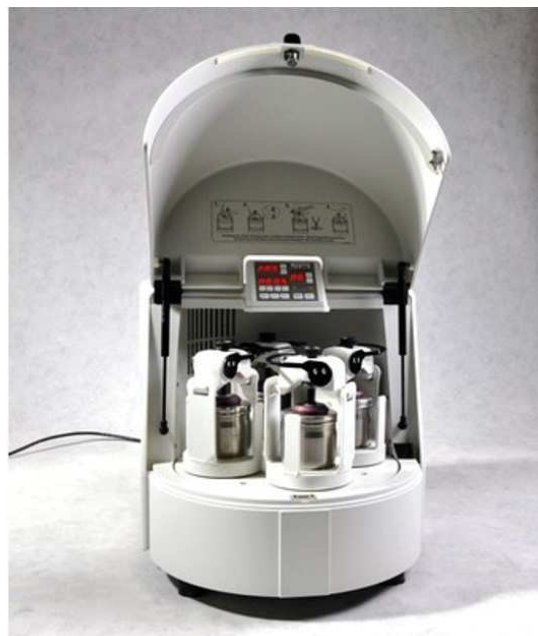
Figure 39 : schéma de mouvement des jarres et Pulvérisette 5 de Fritsch
