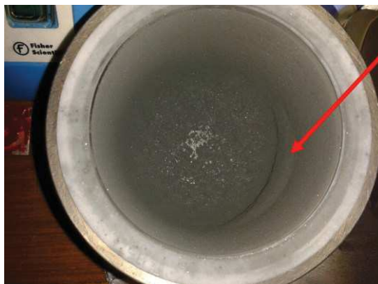
Figure 132 : photographie d'un bol de broyage après un broyage de 3h montrant l'épaisseur de la couche agglomérée (flèche)
