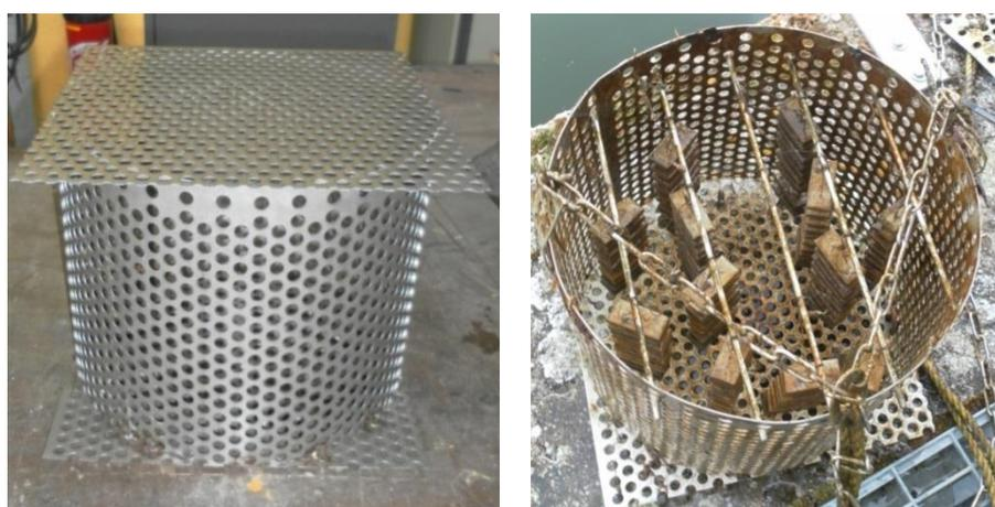
Figure II-15 : Photo d'un panier de protection et des lots d'échantillons immergés en milieu naturel
