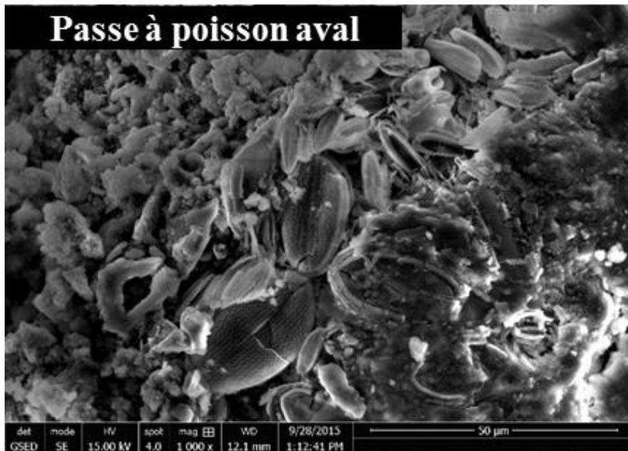
Figure V-25 : Images MEB-PC du prélèvement de béton réalisé sur la passe à poissons dans la zone de marnage, observation d'une tranche sciée
