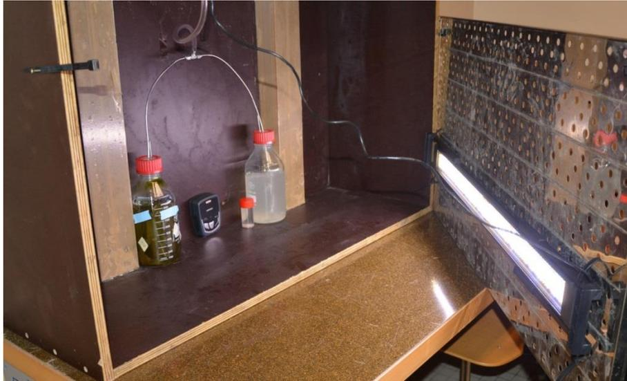
Figure IV-1 : Photo de la chambre d'incubation expérimentale pour la culture des diatomées
