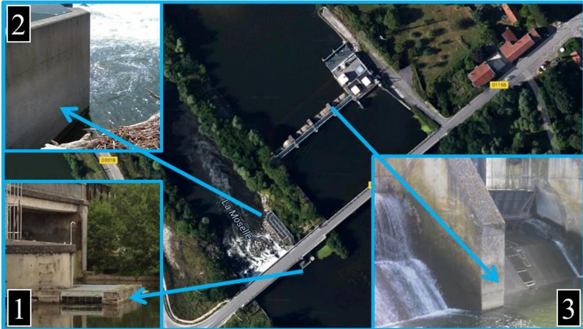
Figure V-22 : Zones de carottage sur le barrage de Méréville
