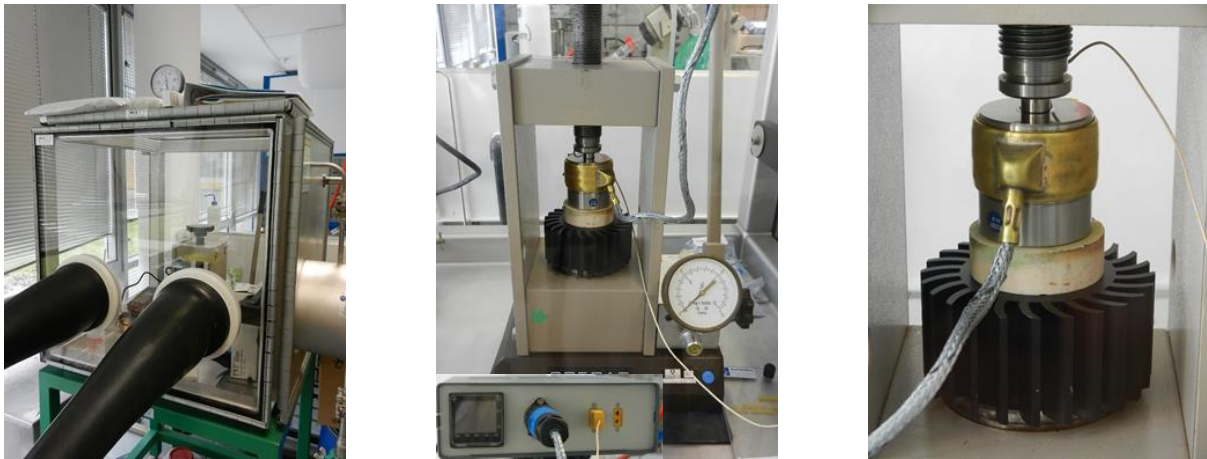
Figure 15 – Montage laboratoire de la presse à chaud.
