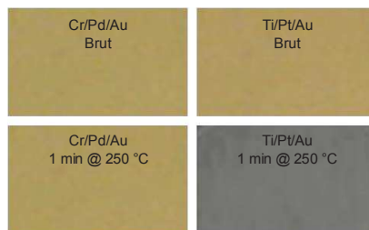
Figure 4.8 : Photographies des états de surface des métallisations Cr/Pd/Au et Ti/Pt/Au avant et après recuit d'une minute à 250 °C.
