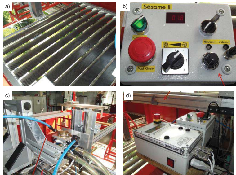
Figure 4.35 : Photographies a) des volets orientables ; b) du boîtier de commande des volets ; c) du système de refroidissement ; d) du boîtier de gestion du positionnement des cellules au foyer de la parabole.
