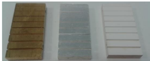
Figure 56: Plaque de laiton brute (gauche), ayant subi un pré-argentage (centre) et recouvert du dépôt d'argent (droite)
