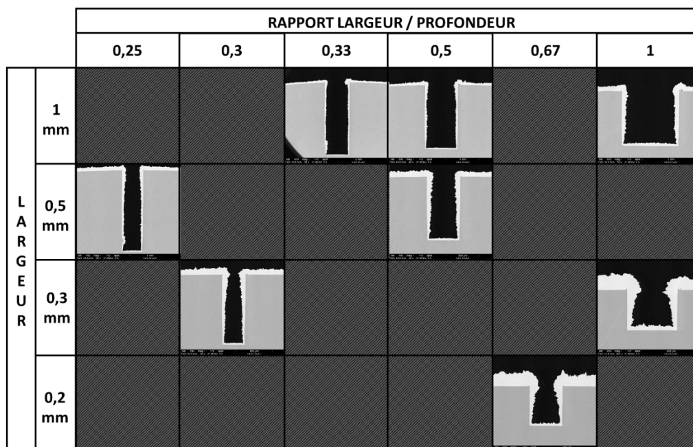
Figure 127 : Vue de coupe des revêtements réalisés en absence d'agitation
