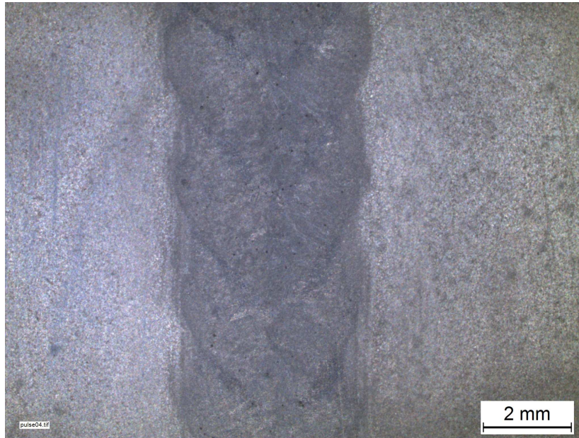
FIGURE 4.25 – Micrographie de la face envers d’une ligne de fusion réalisée en courant pulsé. Le sens de soudage est du bas de l’image vers le haut de l’image.
