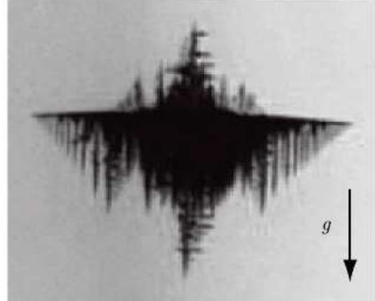
FIGURE 1.18 – Image d'un grain équiaxe d'un cristal de  $NH_4Cl$  présentant une croissance préférentielle vers le bas à cause de l'écoulement du bas vers le haut dans lequel il est plongé. Le vecteur  $g$  représente l'accélération de la pesanteur. L'écoulement est généré par la chute par gravité du grain en pleine croissance [1].
