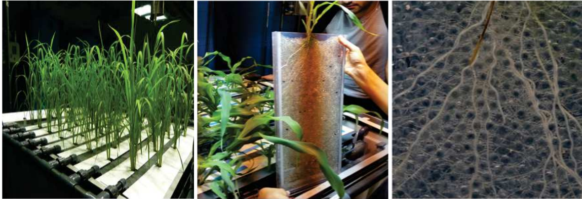
FIGURE 1.1 – Expériences de croissance de racines de riz dans le Rhizoscope : les plantes sont placées dans des boîtes en plexiglas (les Rhizobox") contenant des couches de billes de verre de différentes dimensions. Les plantes poussent dans une solution hydroponique et tous les paramètres environnementaux sont fixes et contrôlés. La croissance des racines et le mouvement des billes de verre sont suivis et analysés par étapes en utilisant des scanners et des outils informatiques dédiés Ahmadi et al. (2014) .
