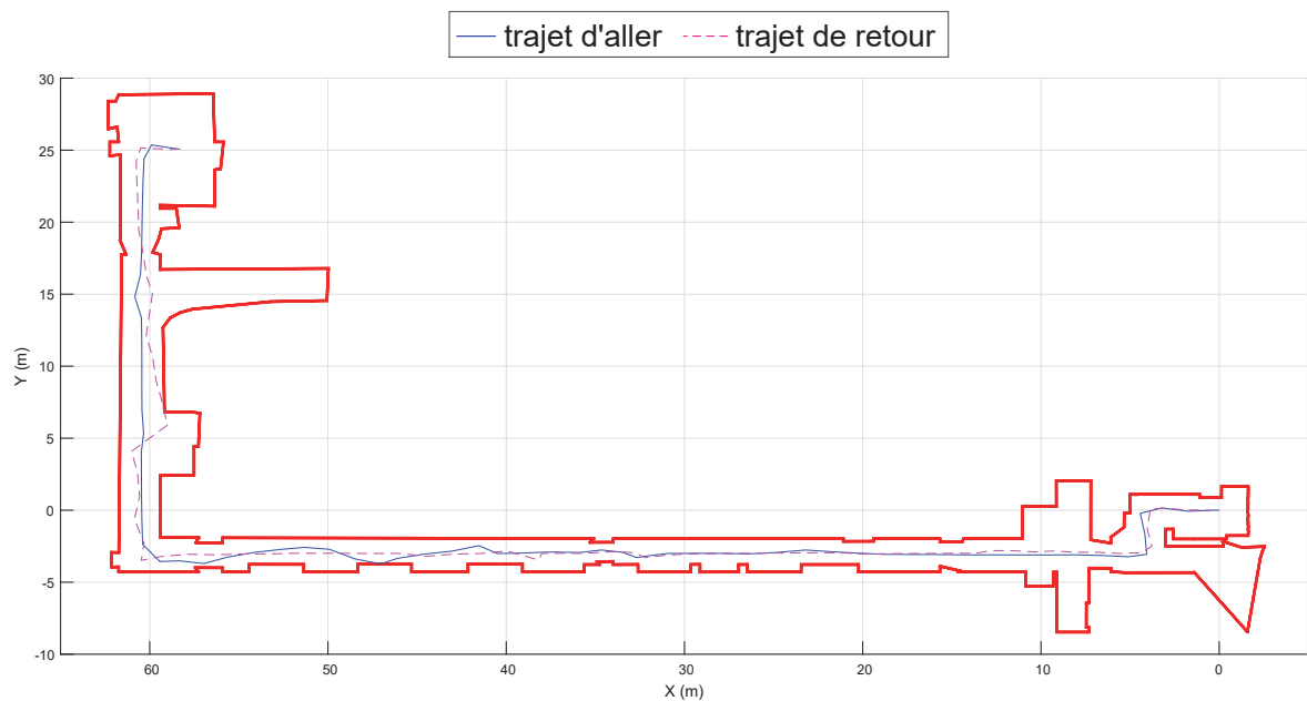
FIGURE 5.9 – Trajectoire du robot lors de la mission de patrouille : elle est construite à partir des données odométriques recalées lors du passage à proximité des QR-codes
