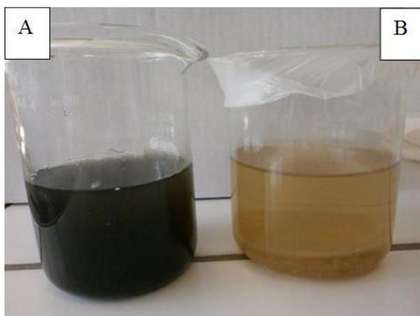
Figure 4 : Photo des anolytes des PCMs ; Sans [BMIm][AcO] (photo A) et en présence de 10 mM [BMIm][AcO] (photo B).
