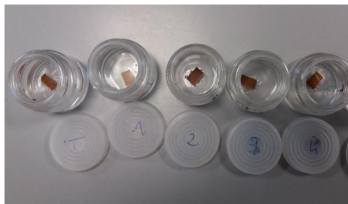
Figure 27 : Echantillon de la membrane d'échange d'ions utilisées pour étudier l'effet de différents LIs.
