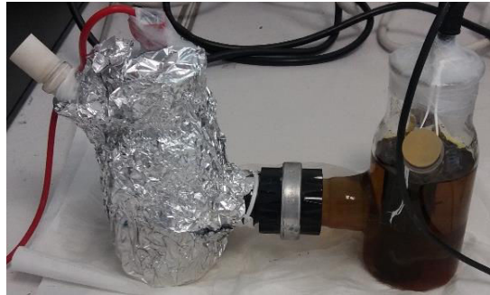
Figure 9 : PCM du laboratoire de type "H", constituée des compartiments anodique (à gauche) et cathodique (à droite).
