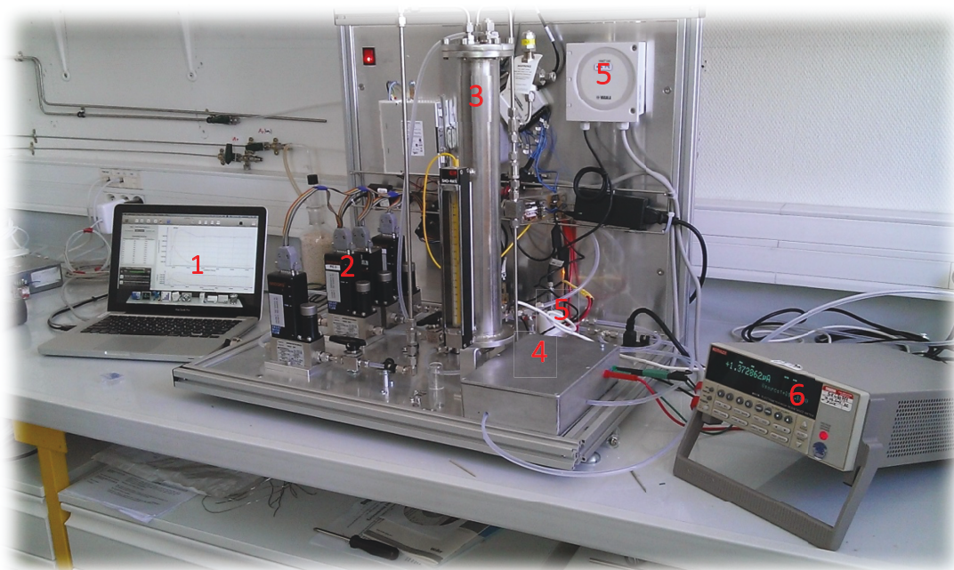
Figure 3 : Photo du banc de mesure utilisé au laboratoire. Gauche : ordinateur permettant le pilotage du banc et du Keithley (1) ; centre : platine de mesure avec régulateurs de débits massiques (2), colonne d'eau (3), cellule de mesure (4) et capteur d'humidité (5) ; droite : Keithley (6).
