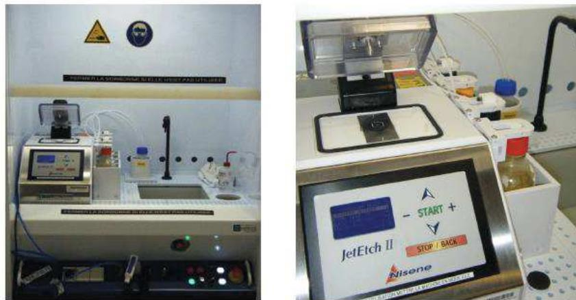
Figure II-3: Outil d'ouverture chimique de la face avant [14]
