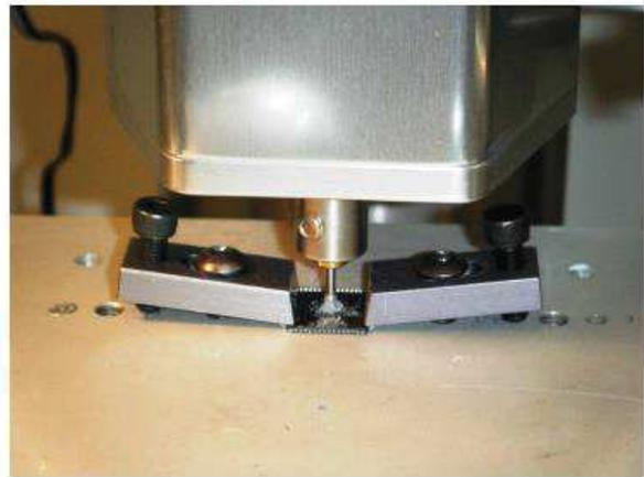
Figure II-4: Outil mécanique d'amincissement en face arrière [14]
