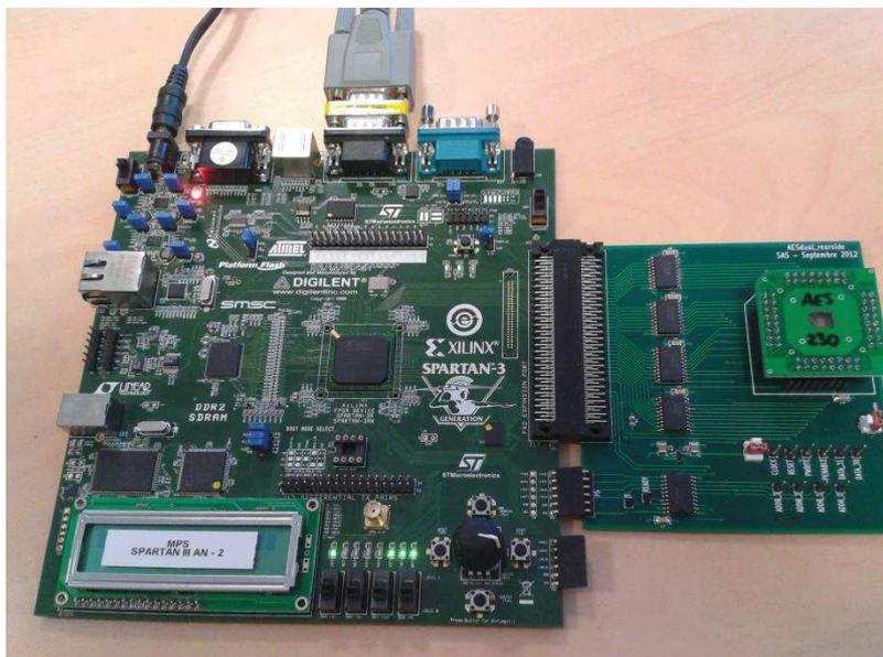
Figure II-8: Montage expérimental (FPGA, carte fille et circuit)
