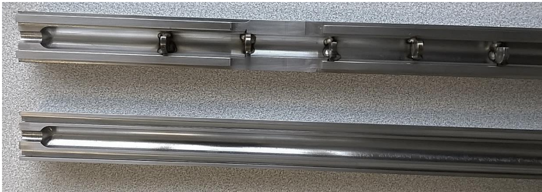
Figure 52 : Photographie d'une partie des demi-coquilles (extrémités coté chaud).
