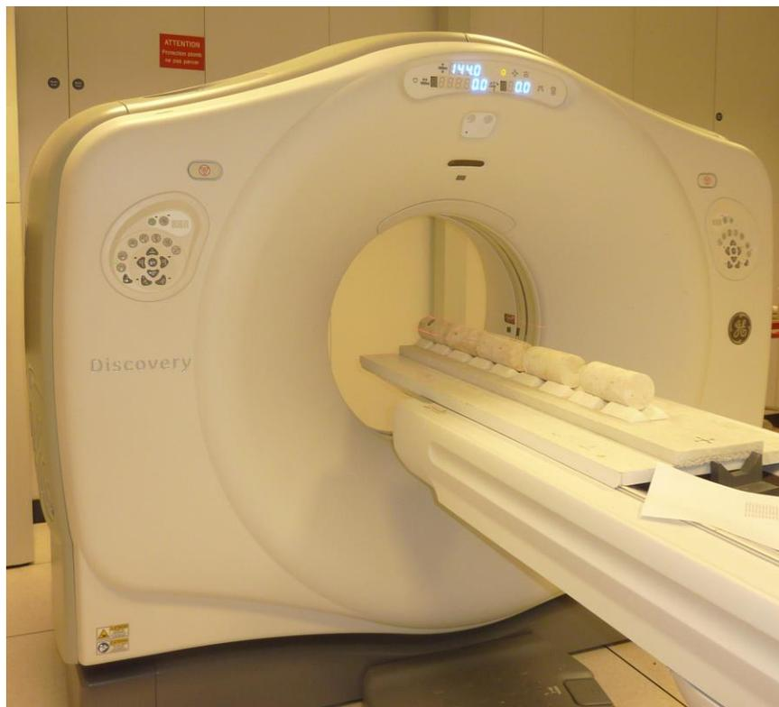
**Figure II-3** : Scanner médial du CSTJF-Total (Pau) avec 5 carottes provenant d'Yport sur le banc d'acquisition. Longueur totale environ 1 mètre.
