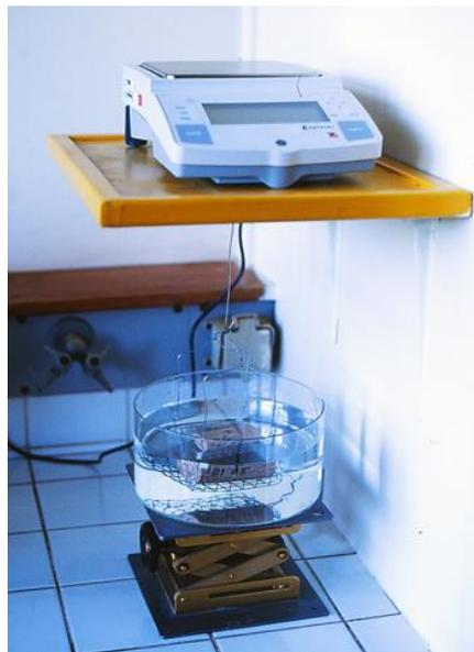
**Figure II-8 :** Vue générale du dispositif de mesure de la masse immergée ( $M_{\text{im}}$ ) d'un échantillon saturé.
