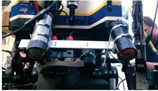
Figure I. 22 : Système stéréoscopique pour application sous-marine
