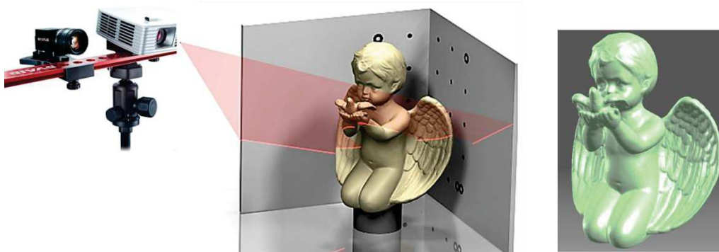
Figure I. 7: Exemples de système actif avec projecteur de lumière
