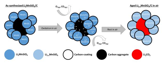
Figure B. Schéma illustrant le mécanisme proposé de réactivité de Li<sub>2</sub>MnSiO<sub>4</sub> avec l'air proposé.
