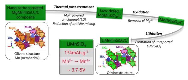
Figure C. Schéma de synthèse en plusieurs étapes de LiMnSiO<sub>4</sub>/C à partir d'un précurseur MgMnSiO<sub>4</sub>/C.
