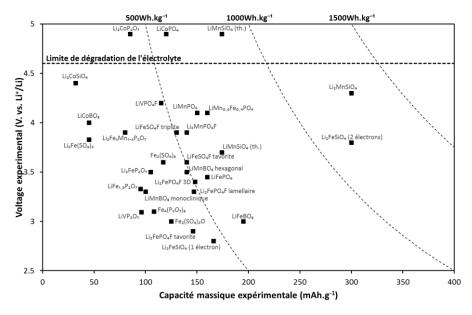
Figure A. Voltage expérimental (V vs. Li<sup>+</sup>/Li) des matériaux polyanioniques en fonction de la capacité massique expérimentale (mAh.g<sup>-1</sup>), les lignes d'isovaleur représentent les densités d'énergie massiques (Wh.kg<sup>-1</sup>); inspiré de [88].
